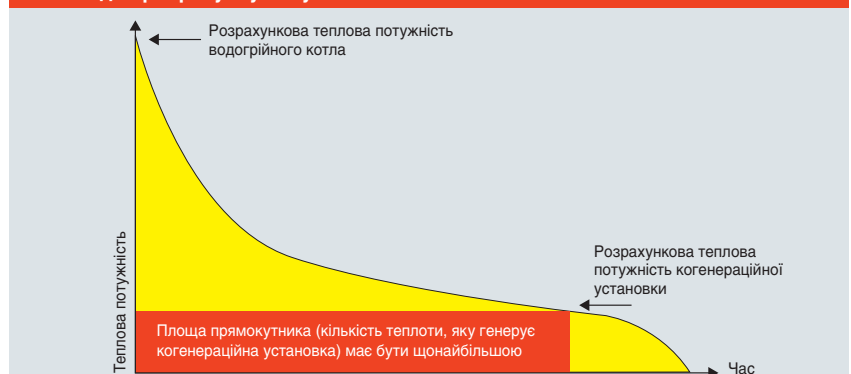
Мал. 4 Річна крива потреби об'єкта в тепловій енергії для розрахунку потужності КГУ
